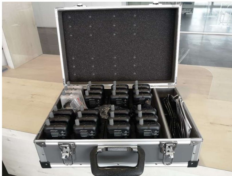
Sistema portátil de inducción magnética para personas con implante coclear (problemas de audición) para su utilización en el Salón de Actos, salas de formación y resto de salas de reunión
